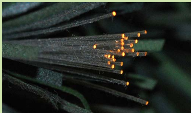
Snop optičnih vlaken, po katerih potuje svetloba. Svetloba je »ujeta« v vlakna, ko pa se vlakno konča, ga svetloba zapusti in jo lahko vidimo ali spremenimo v električni signal.
