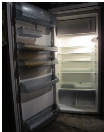
Hladilnik črpa toploto iz hladnejše notranjosti hladilnika v toplejšo kuhinjo.
